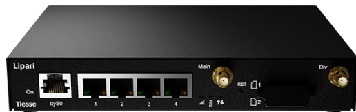
Vista frontale con protezione per slot SIM chiusa
